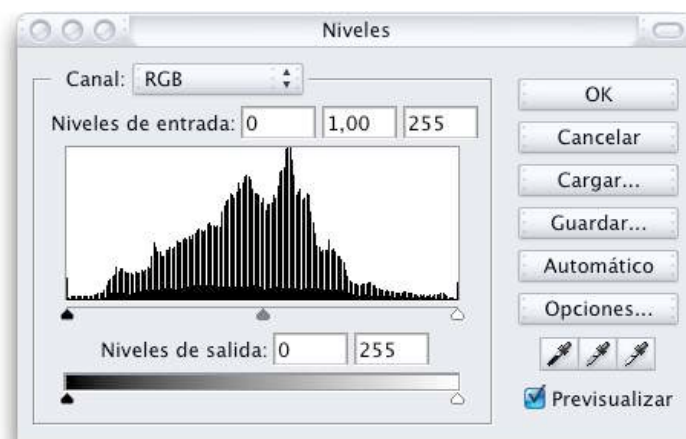
Histograma de la imagen a 8 bits con el “peine de la muerte”
